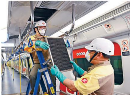
■港鐵為了保障乘客健康，加強防疫措施，包括加密清洗和更換車廂空調系統的隔塵網及增設車站消毒站。
